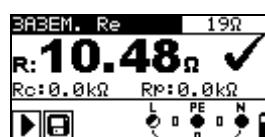
Рисунок 5.38: Пример результатов измерения сопротивления заземления
