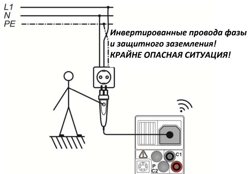
Рисунок С.4: Инвертированные проводники *L* и *PE*
