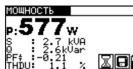
Рисунок 5.47: Результаты измерения мощности
