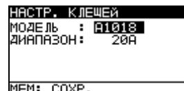
Рисунок 4.12: Настройка конфигурации измерительного входа токоизмерительных клещей
