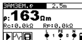
Рисунок 5.42: Пример результатов измерения удельного сопротивления грунта
