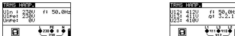
Рисунок 5.4: Примеры измерения напряжения в трехфазной цепи
