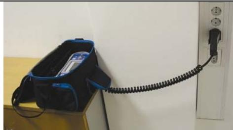
Прибор может использоваться даже в мягкой сумке для переноски – испытательный кабель, подключается к прибору через отверстие в сумке спереди.
