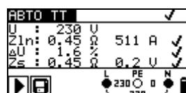
Рисунок 6.6: Пример с результатами автоматической последовательности AUTO TT
