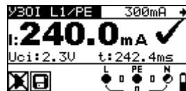
Рисунок 5.23: Пример результата измерения тока отключения
