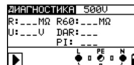
Рисунок 5.9: Меню диагностических испытаний
