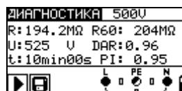
Рисунок 5.10: Пример с результатами диагностических испытаний PI и DAR
