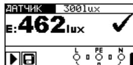
Рисунок 5.58: Пример результата измерения освещенности
