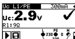
Рисунок 5.21: Пример результатов измерений контактного напряжения
