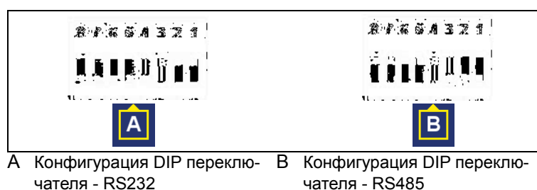
Рис. 10-8: Переключатель DIP режимов интерфейса
