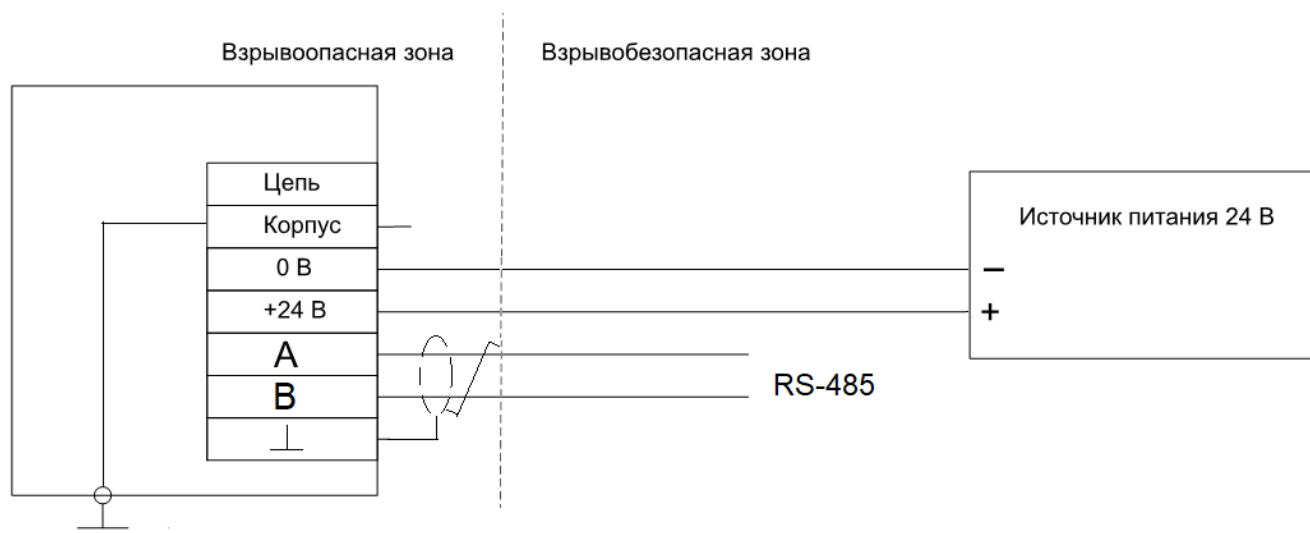
Рисунок Б.5 Схема подключения уровнемера РИЗУР-6000 без взрывозащиты или с взрывозащитой вида «взрывонепроницаемая оболочка» с выходным сигналом RS-485.
