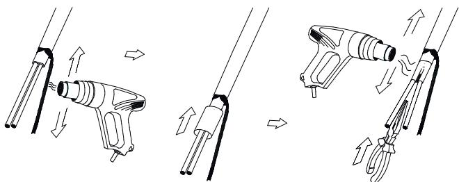
Осадите термоусадочную трубку на жиле техническим феном, на греющий кабель наденьте термоусадку, техническим феном осадите термоусадку и пассатижами сожмите нагретую термоусадку.
