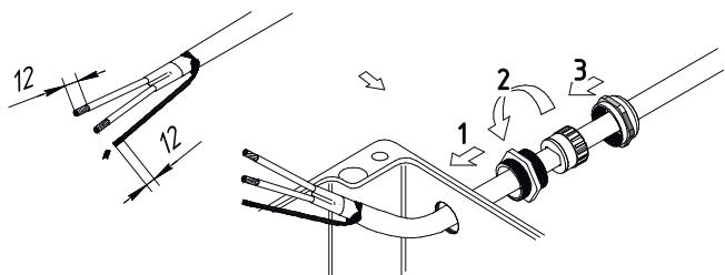
Подготовьте жилы и оплетку для соединения, пропустите разделанный конец греющего кабеля через отверстия и установите кабельный ввод.
