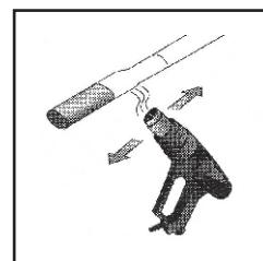
На «ступеньку» надеть резиновый концевик и на кабель термоусадку. Осадить термоусадку техническим феном
