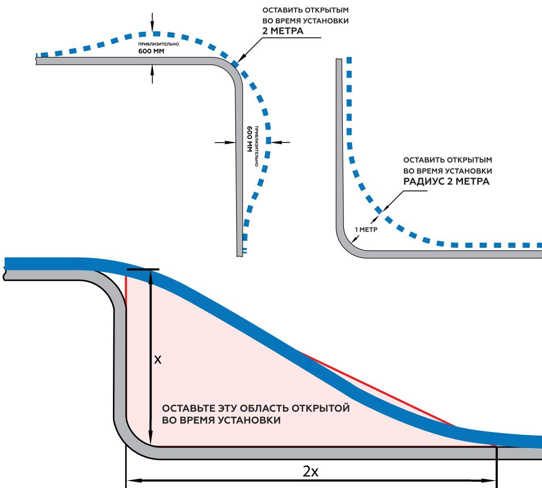
При измении направления от вертикального к горизонтальному или от горизонтального к вертикальному (так называемый «Водопад»), необходимо обеспечить монтажный забор, как показано на схеме.
