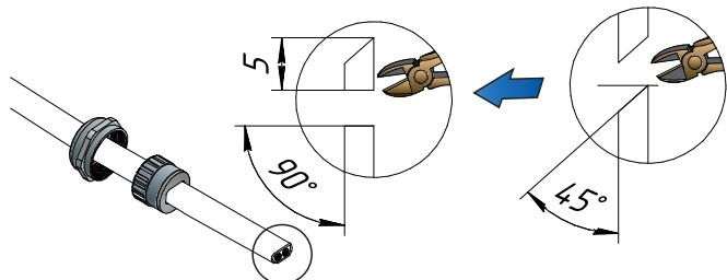
Разместите элементы кабельного ввода на греющем кабеле согласно рисунку.
