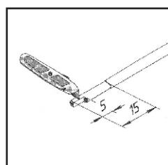
Удалить внешнюю оболочку и экранированную оплетку обрезать торец кабеля «ступенькой»
