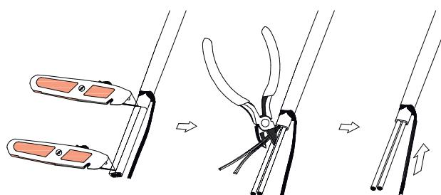
Снимите внутреннюю изоляцию с нагревающего кабеля, наденьте на скрученный жгут термоусадочную трубку.
