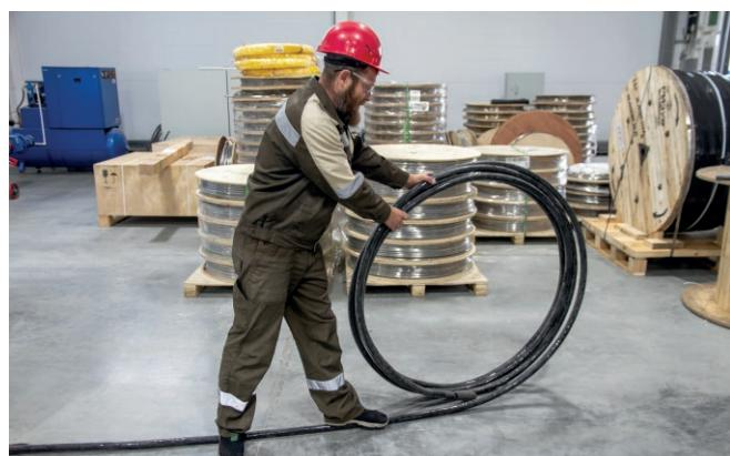
Метод 2. Используйте вторую катушку меньшего размера, чтобы выпрямить РИЗУРПАК®, когда пучок трубок снимается с транспортировочной катушки.
